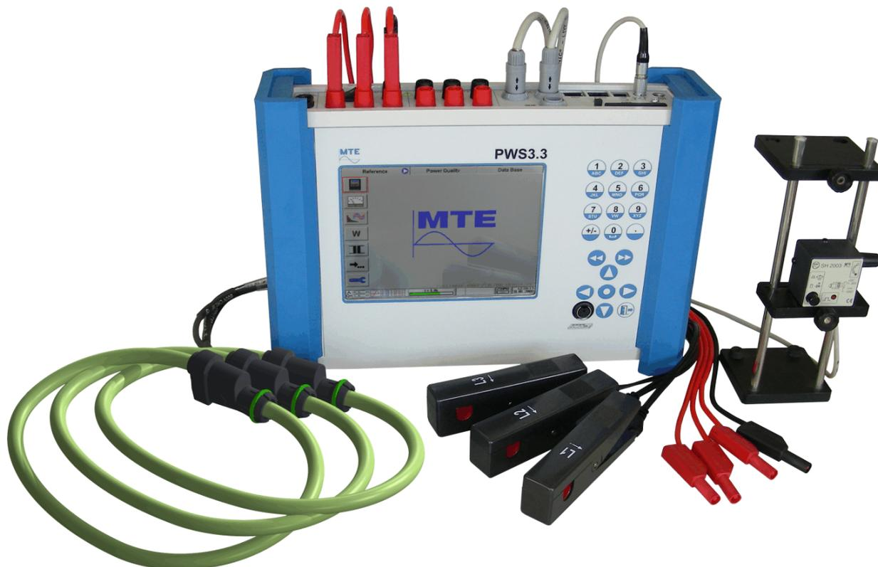
PWS 3.3 – это прибор, сочетающий в себе образцовый трехфазный портативный счетчик класса точности 0,05% или 0,1% и анализатор качества электрической энергии, соответствующий стандарту МЭК 61000-4-30 класса А с 3-мя каналами измерения по напряжению и 4-мя каналами по току.
